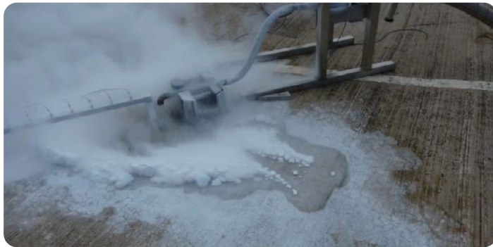
<그림 4> 액화수소가 바닥에 확산되는 상태
