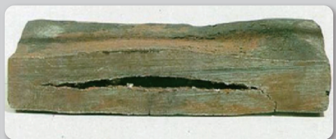
<그림 9> 수소 블리스터링 발생기전(좌), 손상된 금속재료(우)
